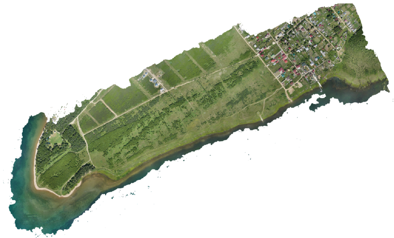
Рис. 4. Ортофотоплан местности (фрагмент Иркутского водохранилища). Съемка с БПЛА на высоте 220 м
